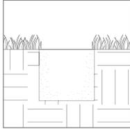
El hueco debe de tener una profundidad de por lo menos 3 cm adicionales a la altura de la luminaria y debe contar con un sistema de drenaje, esto para impedir que el hueco permita filtraciones que puedan dañar la luminaria.
