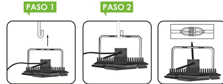
Esquema de conexión del circuito
