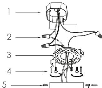
5. Asegurar colgante enroscando a placa sujetadora
